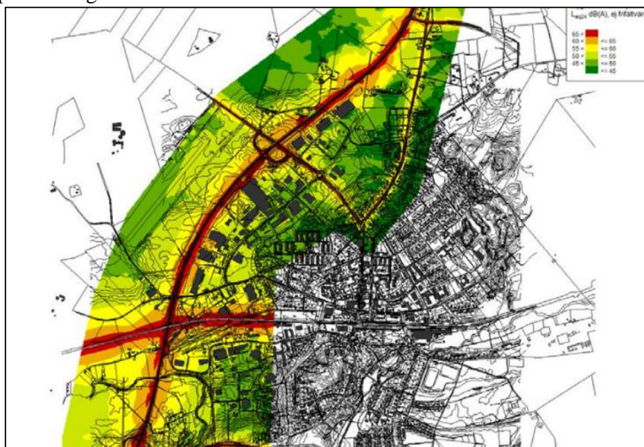
Bild 10. Bullerkarta som visar nuläget och dygnsekvivalent ljudnivå i dB(A) för sammanvägd ljudnivå från väg- och spårtrafik. Kartan visar ljudnivån på höjden 2 m över mark. Källa: Trafikverkets PM Buller E20 förbi Vårgårda 2017-10-13.
