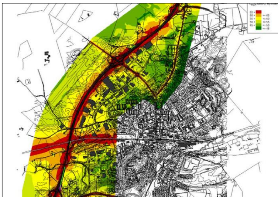
Bild 11. Bullerkarta som visar utbyggnadsalternativet år 2040 med föreslagna bullerskyddsåtgärder (gröna linjer på bullerskärmar och lilla linje på bullervall) nära E20 och dygnsekvivalent ljudnivå i dB(A) för sammanvägd ljudnivå från väg- och spårtrafik. Kartan visar ljudnivån på höjden 2 m över mark. Källa: Trafikverkets PM Buller E20 förbi Vårgårda 2017-10-13.
