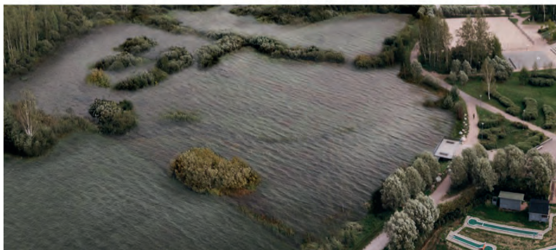
Exemplet från Kirkkojärvi i Finland visar hur en GC-väg kan skydda fastigheter mot höga flöden. En mötesplats har anlagts vid den smala bäcken. Åprofilen har breddats och fördjupats här för att bevara en vattenspegel även vid låga flöden.
