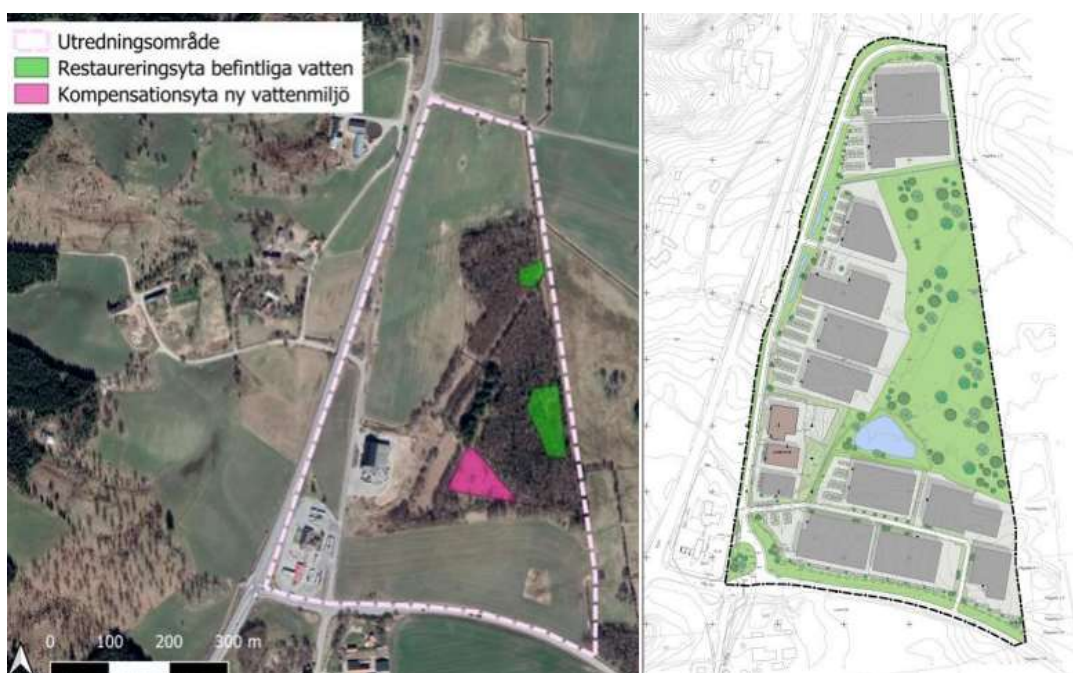
Figur 10. Ortofoto (där röd polygon visar möjlig placering och utformning av damm och grön polygon visar områden där restaurering i form av skydds- och förstärkningsåtgärder föreslås, i bilden till vänster) inklusive illustrationskarta, i bilden till höger som visar våtmarkskomplex inkl. kompensationsdamm, inom planområdet. (Källa figur: EnviroPlanning 2021).
