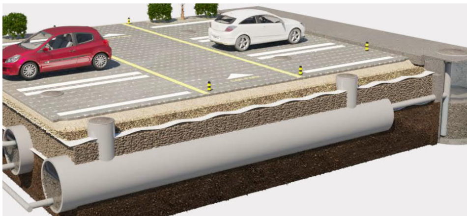
Figur 34. Exempel på fördröjning och rening i rörmagasin. Bildkälla: Weric AB
