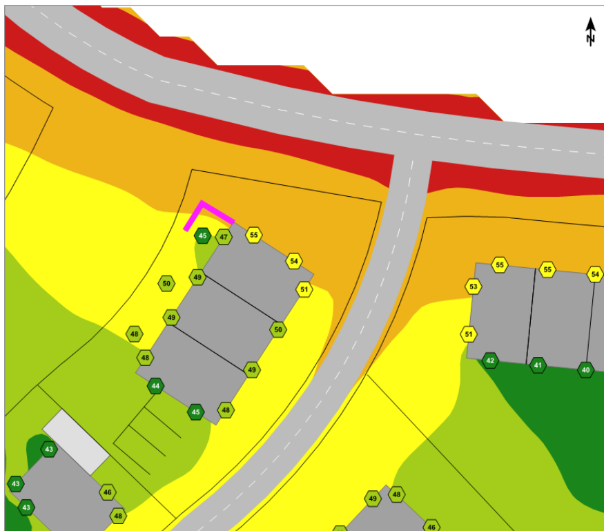
Figur 19 Dygnsekvivalent ljudnivå vid två uteplatser i nordväst där riktvärdet överskrids utan åtgärd, med 2 meter hög bullerskyddsskärm vid uteplatsen närmast vägen (punkter visar frifältsvärden, spridningsberäkning visar inte frifältsvärden vid fasad).
