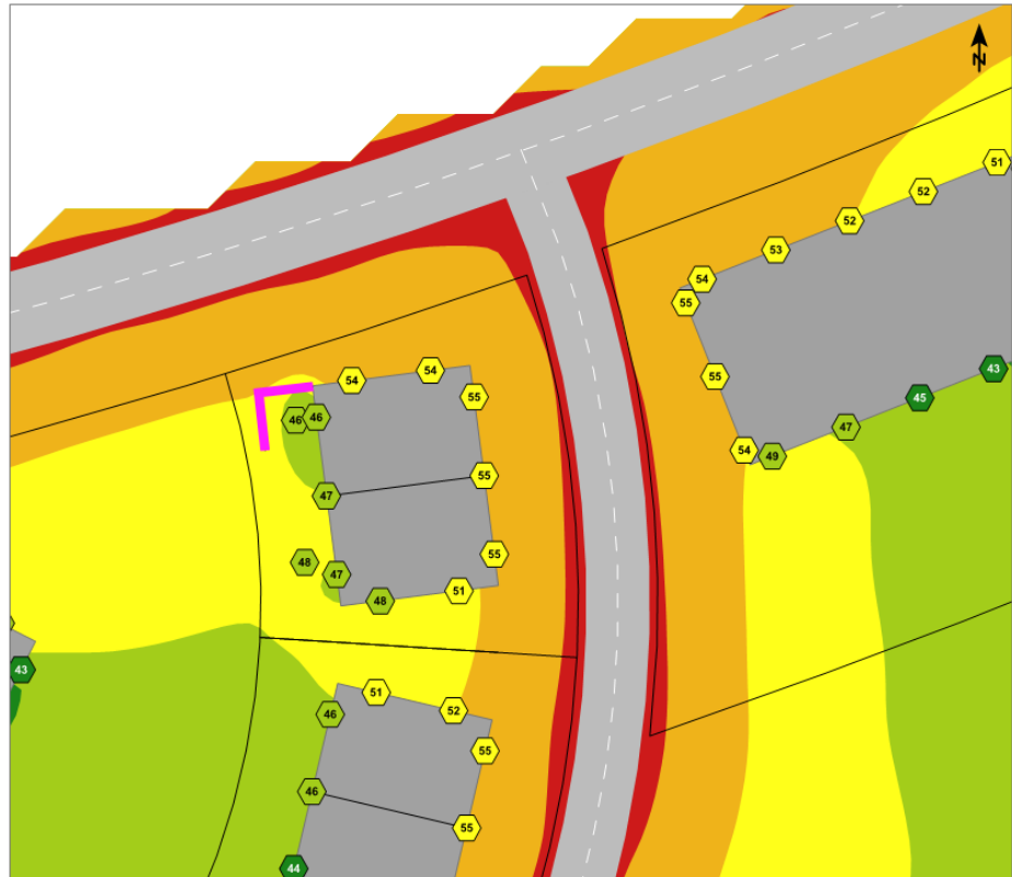
Figur 21 Dygnsekvivalent ljudnivå vid uteplats i nordost där riktvärdet överskrids utan åtgärd, med 2 meter hög bullerskyddsskärm vid uteplatsen (punkter visar frifältsvärden, spridningsberäkning visar inte frifältsvärden vid fasad).
