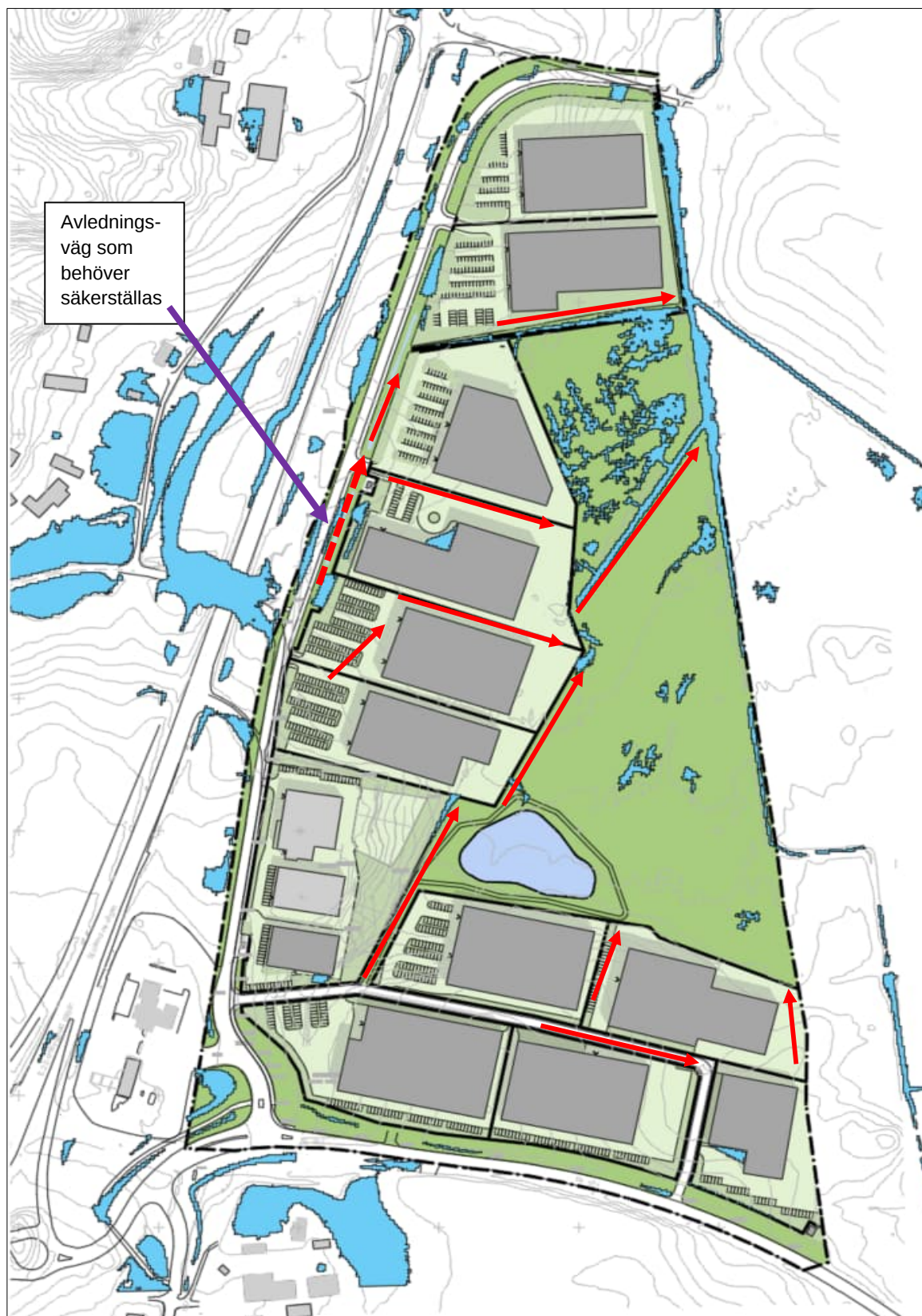
Figur 4. Simulerad marköversvämning vid ett 100 årsregn (december 2025) med illustrationskartan som bakgrund. Bildkälla: plankarta (AL Studio AB) och underlag från Scalgo Live bearbetat i AutoCad. Rinnvägar visas med röda pilar.
