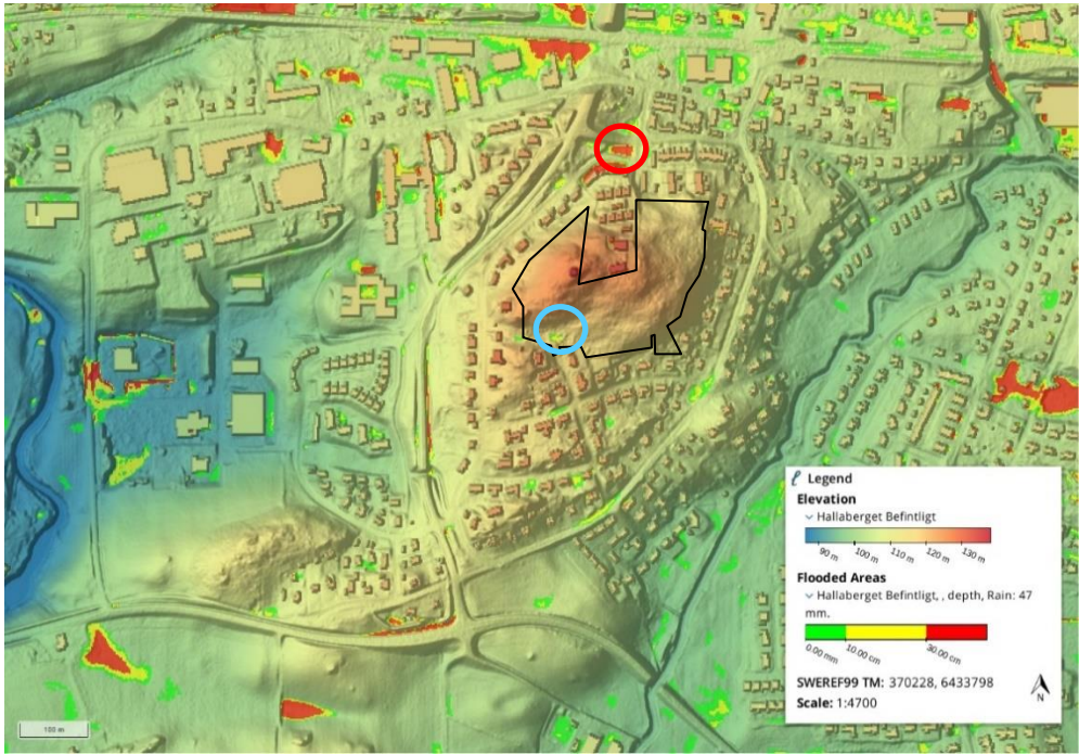
Figur 14. Potentiell befintlig översvämningsutbredning och vattendjup då 47 mm nederbörd (motsvarande 100-årsregn med klimatfaktor 1,25) appliceras i Scalgo Live. Utdrag från Scalgo Live. Röd ring= lågpunkt i norr, Blå ring= lågpunkt i söder.
