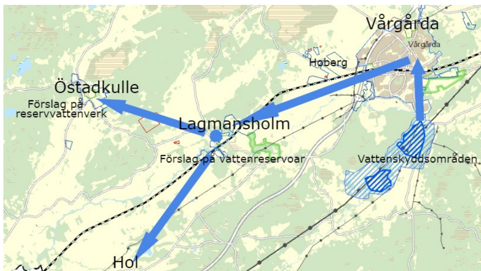
Figur 4: Principskiss över vattendistributionsnätet
